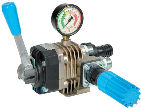
**Centralina ad alta pressione (50 bar), ad un comando di selezione dx/sin-by-pass. Dotata di regolatore di pressione di precisione a membrana con supporto e sede scarico in ceramica antiusura. Completa di manometro graduato su corpo nichelato e sedi direzionali del flusso in acciaio inox Aisi 316. Collaudata sul campo anche nelle condizioni d'uso più gravose (acqua sabbiosa).**
